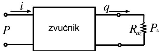
*Slika 16.1 – Zvučnik kao četvoropol sa naznačenim načinom nastanka akustičke snage na njegovom izlazu*
