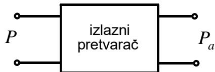
*Slika 14.3 – Izlazni elektroakustički pretvarač sa označenim ulaznim i izlaznim veličinama*
