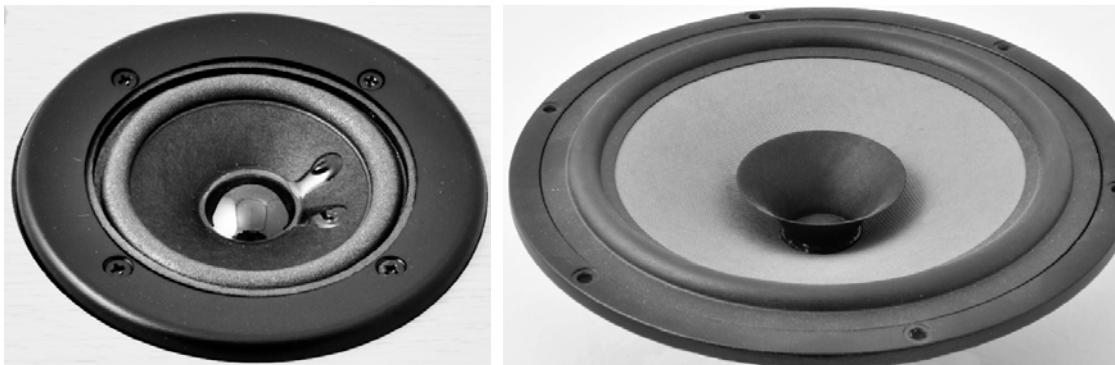
*Slika 16.7 – Fotografije dve zvučničke membrane gde se vide konusne i kalotne forme*
