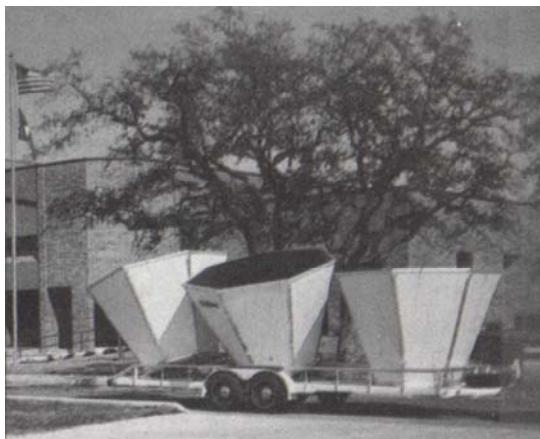
SODAR emituje naviše u atmosferu kratak zvučni impuls, a zatim prelazi u režim osluškivanja u kome registruje refleksije koje se vraćaju od diskontinuiteta vazduha. Na osnovu vremena kašnjenja pristiglih refleksija određuju se visine na kojima se javljaju diskontinuiteti, a na osnovu relativnog intenziteta pristiglog reflektovanog talasa može se odrediti veličina tog diskontinuiteta.
