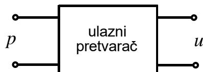
Slika 14.2 – Ulagni elektroakustički pretvarač sa označenom ulaznom i izlaznom veličinom
