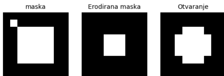
Slika 6.3. Ilustracija erozije i otvaranja pomoću strukturnog elementa u obliku krsta
