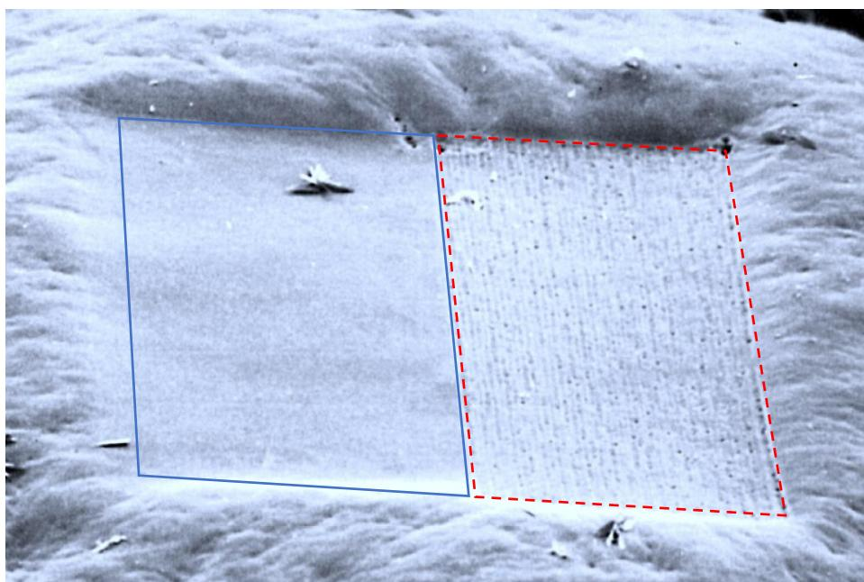
Slika 2.50. Fotografija površine rožnjače nakon aplikacije četvrtog (levo, uokvireno **punom plavom** linijom) i drugog (desno, uokvireno **isprekidanom crvenom** linijom) harmonika Nd:YLF lasera (dužine impulsa 30 ps). Fotografija je adaptirana iz reference (Niemz, 2019).
