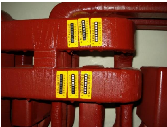
Слика 2.12: Изглед термо трака за мерење температуре
