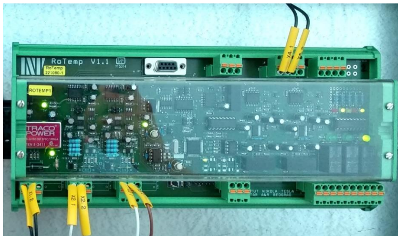
Слика 4.8: Уграђени електронски модул за обраду ROTEMP
