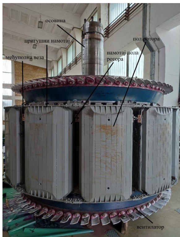
Слика 2.1: Најважнији елементи ротора хидрогенератора
