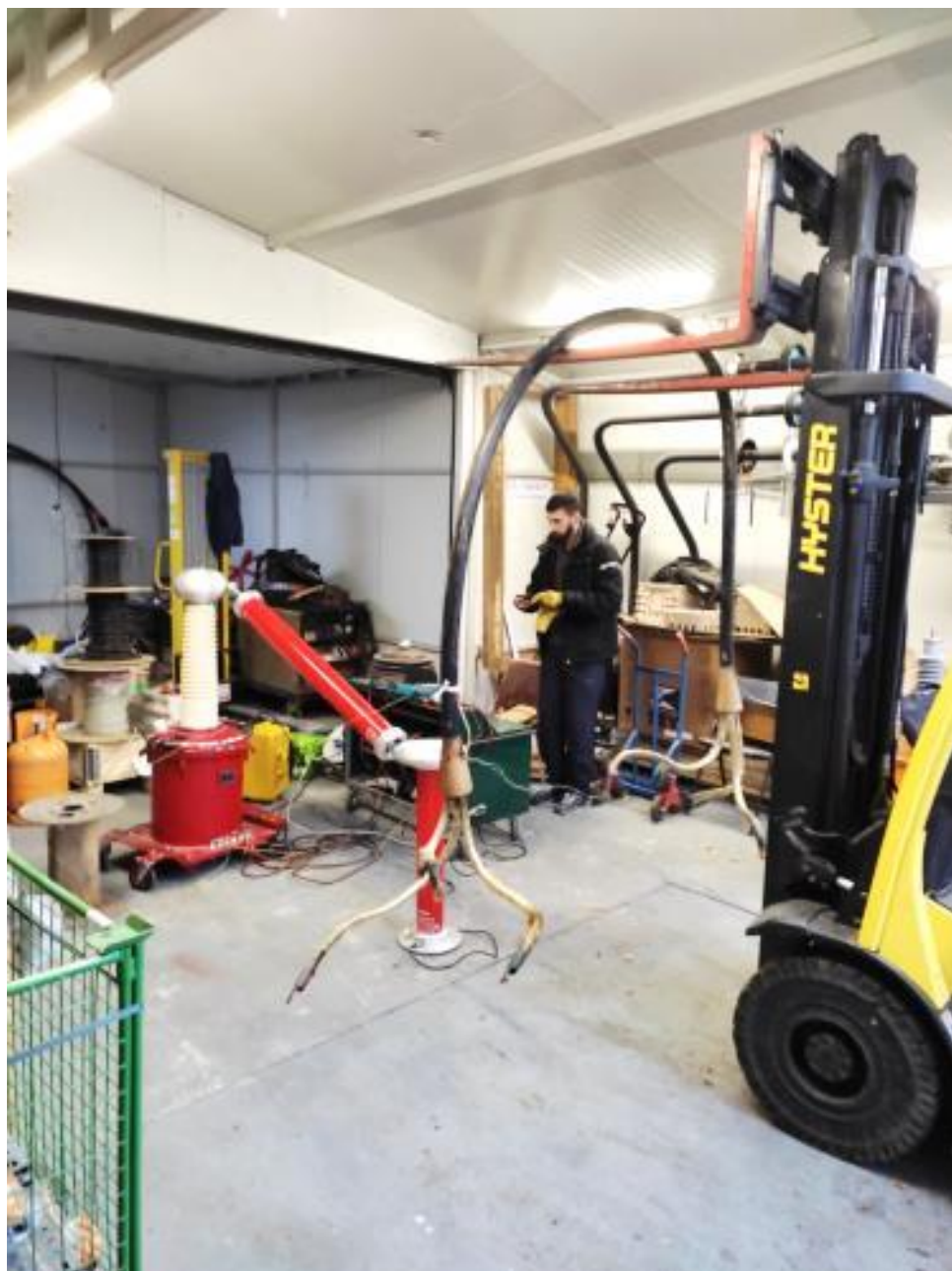
Sl. 9.3 Ispitivanje PDIV i VBD na uzorcima kablova
