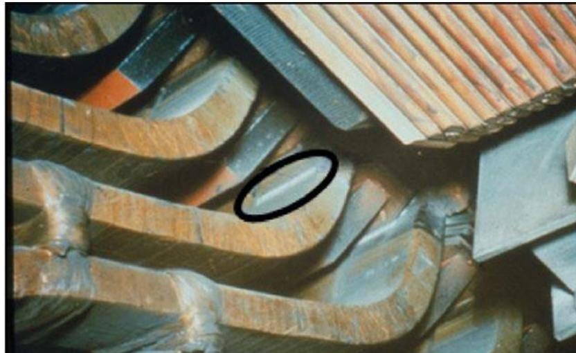
Slika 2.3 - Pojava parcijalnog pražnjenja na kanuri obrtne električne mašine u pogonu
