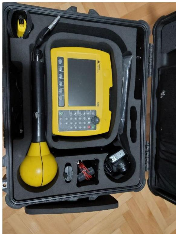
Slika 4.3 - Instrument za merenje nejonizujućeg elektromagnetskog zračenja NARDA SRM 3006
