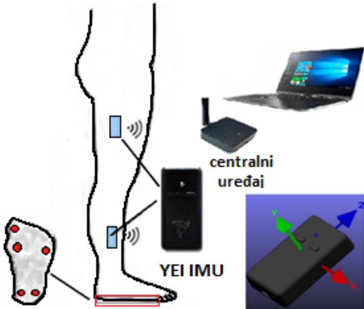
Slika 10. Šema sistema korišćenog u studiji. Walky jedinice bežično komuniciraju sa centralnim uređajem koji je povezan sa računarcem. Prikazana je orijentacija osa IMU (slika dole desno).
