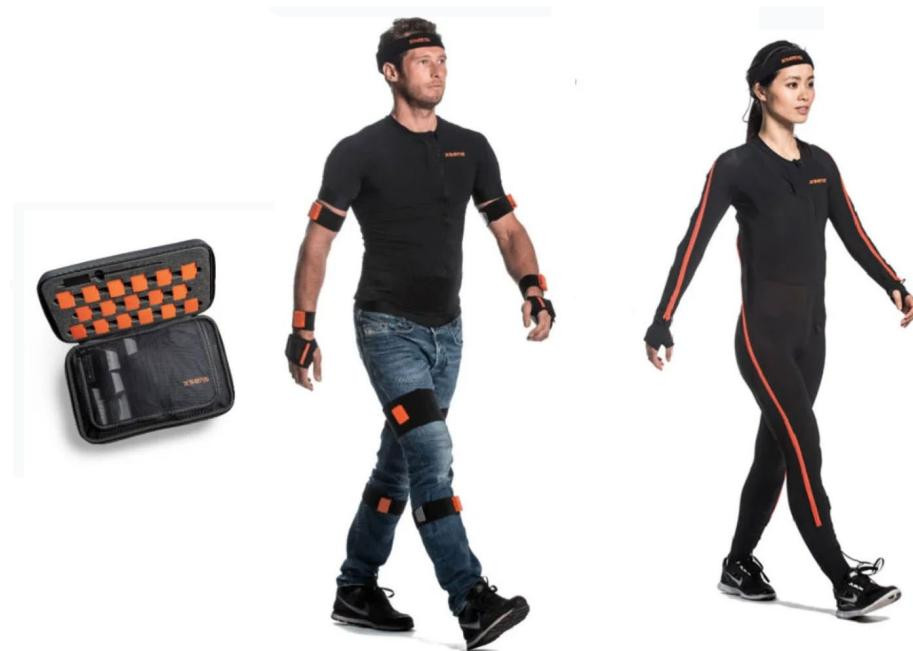
Slika 7. MVN Link i MVN Awinda sistemi sa integrisanim inercijalnim jedinicama [slika zvanično dobijena ljubaznošću Xsens tima i modifikovana.].
