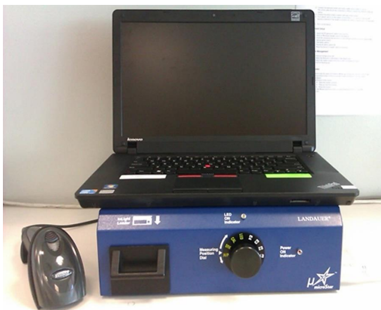
Слика 3.13. Читач microStar, пратећи рачунар и бар-кôд читач [60].
