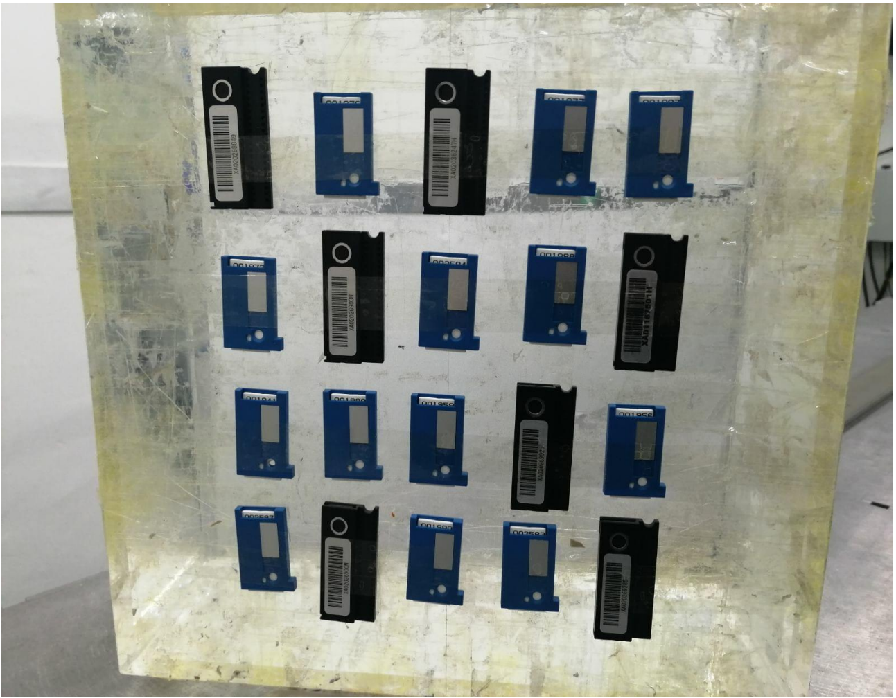
Слика 3.21. Експериментална поставка за одређивање енергетског одзива ТЛ и ОСЛ дозиметара. Приликом сваког поступка озрачивања на фантому су биле присутне све три врсте коришћених дозиметара (MTS-N, MCP-N и InLight).
