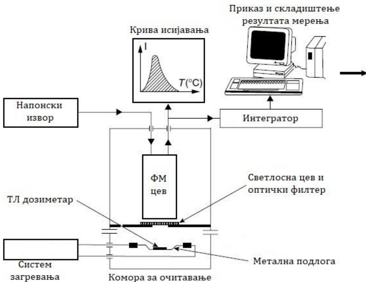
Слика 2.7. Шематски приказ читача ТЛ дозиметара са системом загревања металне подлоге [22].
