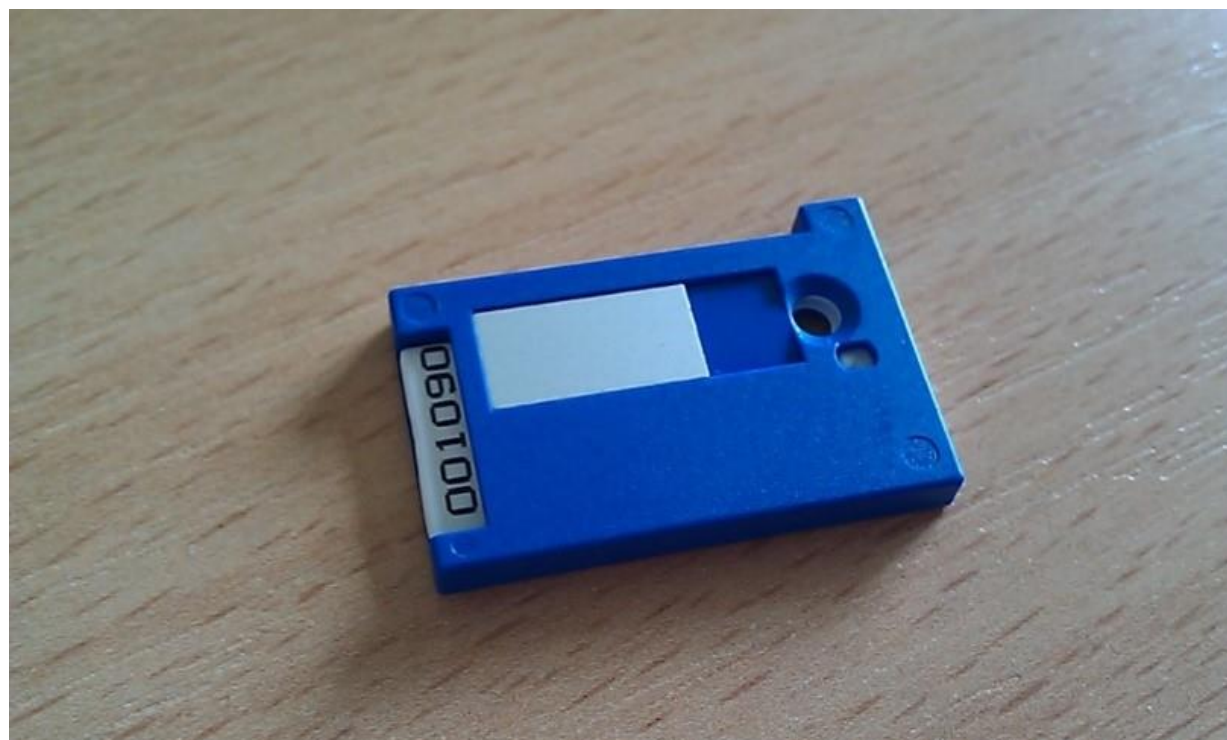
Слика 3.2. ТЛ дозиметар са два детектора испод алуминијумског филтера [52].
