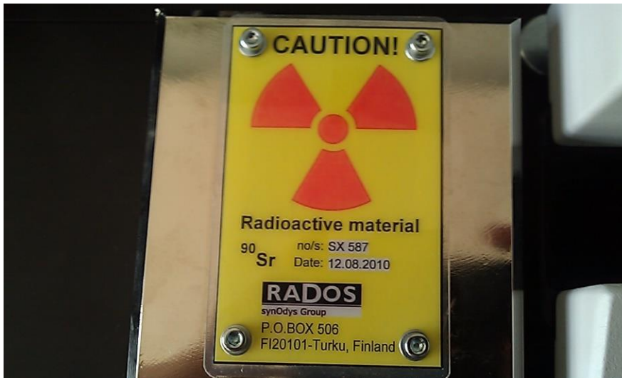
Слика 3.9. Кућиште затвореног извора ^{90}\text{Sr} [53].
