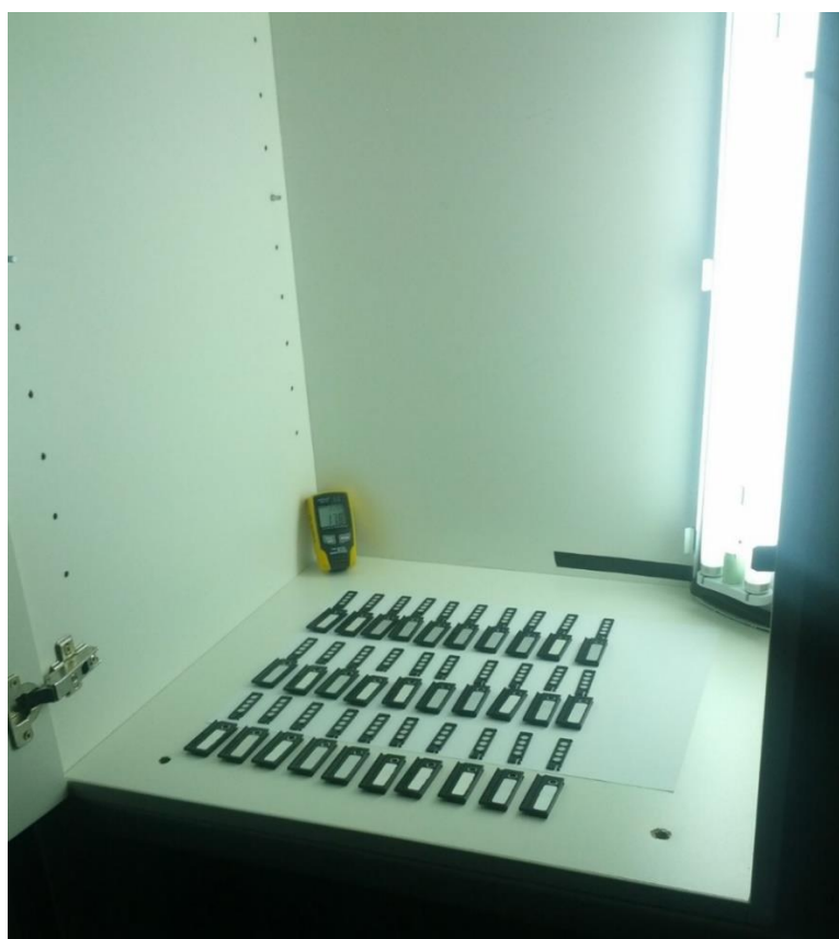
Слика 3.15. Процес отпуштања заробљених наелектрисања InLight дозиметара [63].
