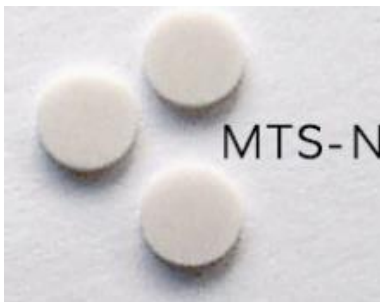
Слика 2.8. Физички изглед MTS-N детекторских елемената [30].
