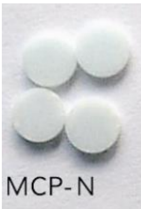
Слика 2.9. Физички изглед МСР-Н детекторских елемената [30].
