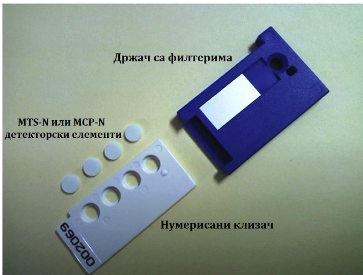
Слика 3.1. Компоненте ТЛ дозиметара – четири MTS-N или MCP-N детекторска елемента, нумерисани клизач и држач са филтерима [52].
