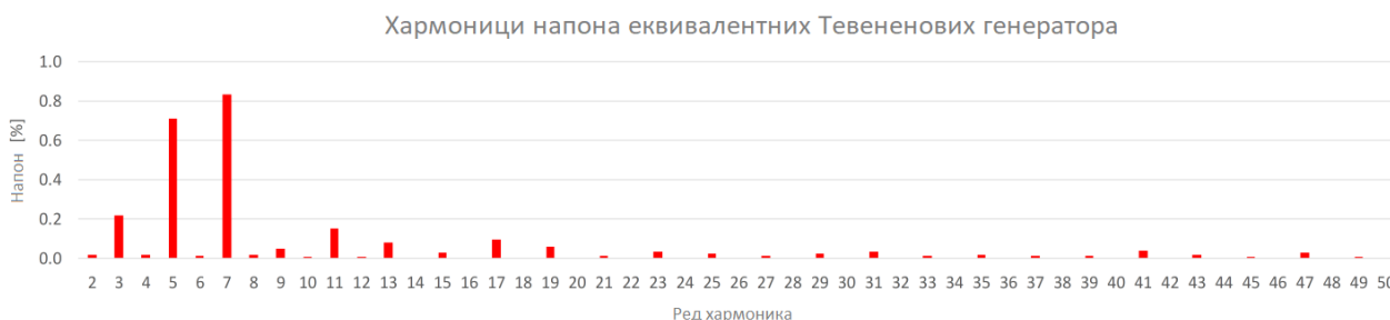
Слика 11. Напони еквивалентних Тевененових генератора, изражени у % основног хармоника напона
