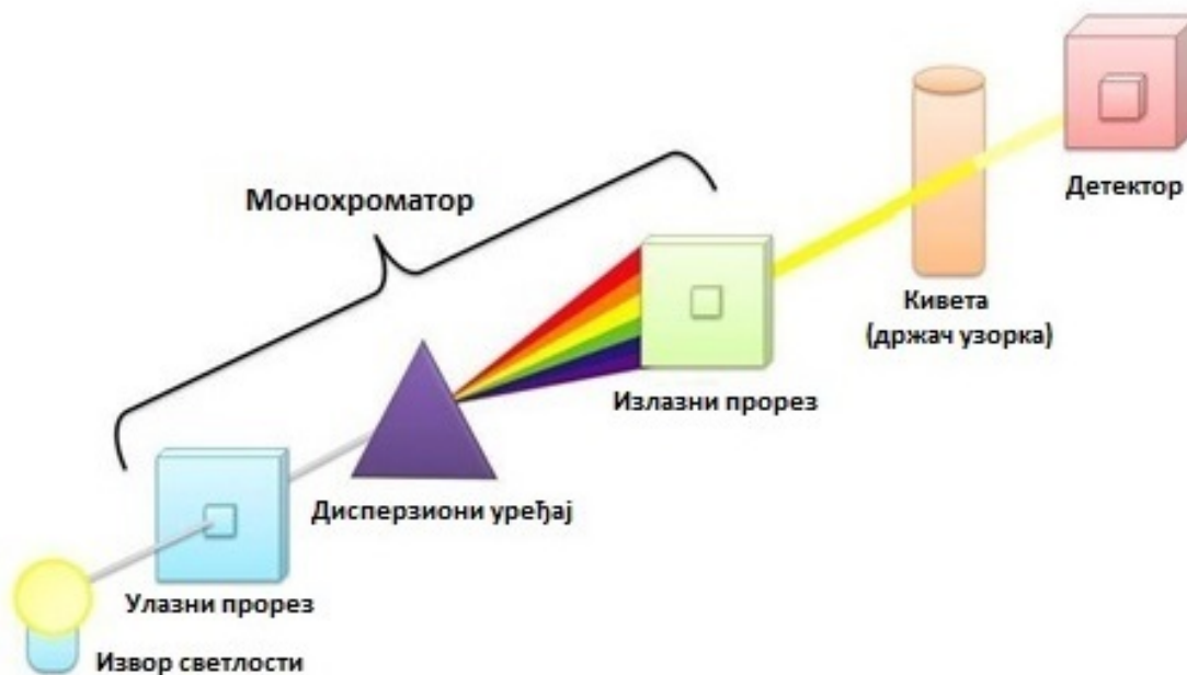
Слика 4.15. Основна шема UV-Vis спектрофотометра (преузето и адаптирано са http://4.bp.blogspot.com/-uQbpRLd-m88/Ue_jKF13DpI/AAAAAAAAAAqE/12BMB53RByg/s1600/Simple+UV-Visible+Spectrophotometer.jpg ).
