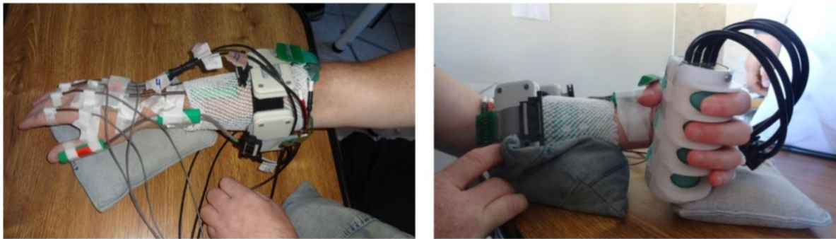
Слика 36 Експериментална поставка за паралелно снимање ЕМГ сигнала и механике покрета: (а) гониометри бележе углове у зглобовима прста приликом њихове флексије и екстензије; (б) динамометар са одвојеним пољима за појединачне прсте дележи силу произведену приликом цилиндричног хвата; по једна матрична електрода 6 \times 4 је постављена на воларну и дорзалну страну подлактице како би се забележили сигнали и са флексора и са екстензора прстију и шаке; свака матрица је повезана на по један „Smarting“ појачавач. Преузето и адаптирано из [5] (Љубазношћу издавача дозвољена је употреба слика у некомерцијалне сврхе)
