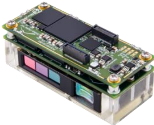
Slika 2.7 Lidar sa MEMS vibrirajućim mikroogledalima [36].
