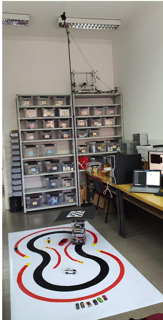
Slika 8.21 Postavka sistema sa novom putanjom za autonomnu vožnju u realnim uslovima, [113].
