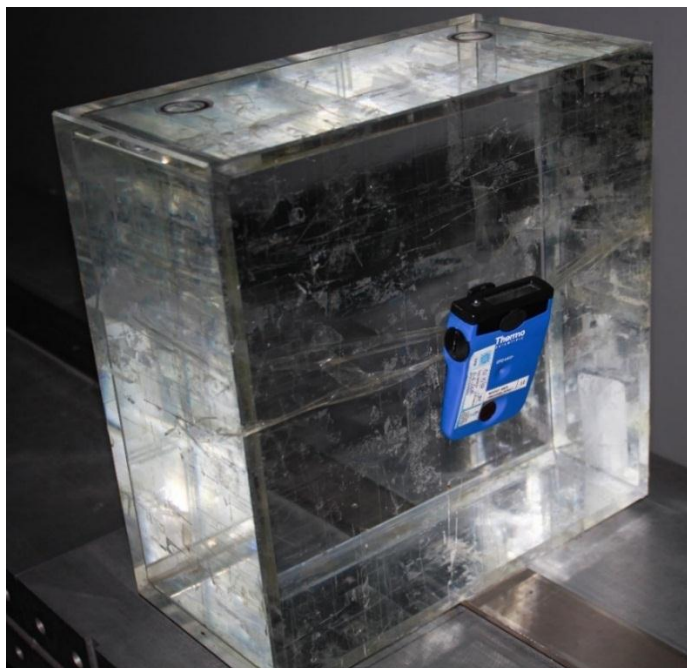
Слика 8.1. Електронски лични дозиметар (EPD) типа EPD Mk2 (Thermo Scientific) постављен на стандардни ISO водени блок фантом. Ентитет фантом-дозиметар је центриран и постављен на калибрациону клупу тако да се референтна тачка дозиметра налази на растојању 2 m од извора зрачења.
