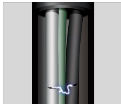
Слика 1. Редни (серијски) електрични лук [21] Слика 2. Паралелни (оточни) електрични лук [21]
