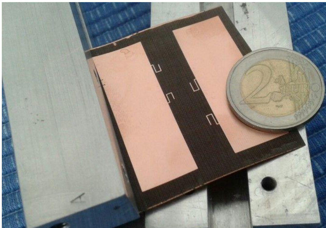
Слика 5.31 Лабораторијски прототип таласоводног филтра другог реда са два непропусна опсега учестаности
