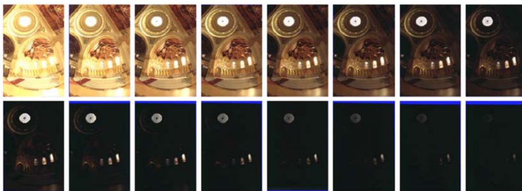
Slika 1.18 Skup od 16 različito eksponiranih LDR slika koje su korišćene za snimanje celokupnog osvetljaja scene [14].
