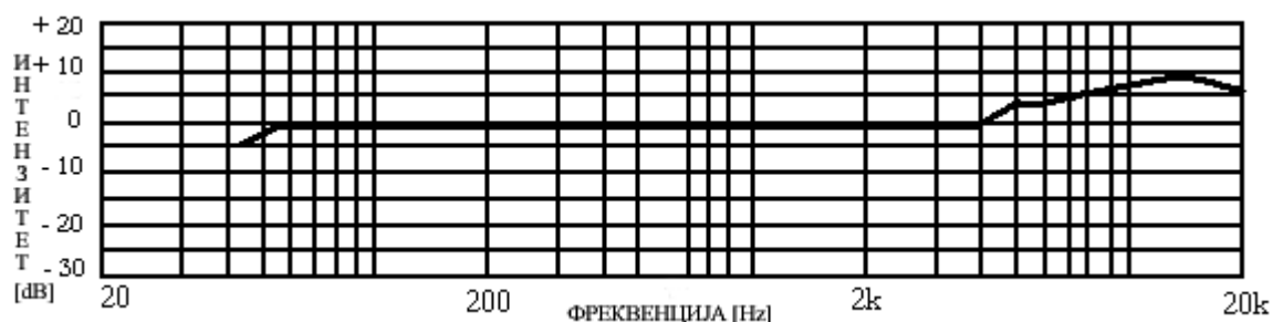
Слика 4.3 Фреквенцијска карактеристика омнидирекционог микрофона.
